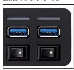
USB機器の電源をON/OFFに切り替 えられる個別スイッチタイプで、個 別アクセスランプを搭載しています。
